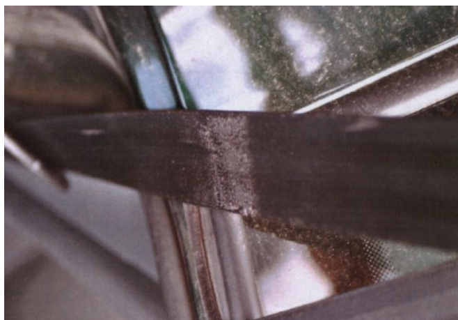
Obr. 2: Typické poškození (natavení vláken) bezpečnostního pásu v místě jeho ukotvení při nárazu
